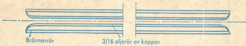
Brännarrörets area minskas som framgår av denna teckning genom att man invändigt läder fast ett 3/16" oljerör av koppar. Mellanrummet kan användas för förvärmning med het vatten.
