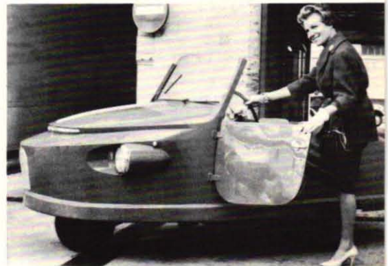
OTI-125 heter denna lilla plastbil tillverkad av den franske ingenjören Paul Villeple. Exemplet på ovanstående bild är bara en prototyp, men enligt konstruktören kommer förmodligen Bugattifabriken att ta upp tillverkningen till 1960. Toppfart 65 km/tim, bensinförbrukning 3-5 l på 10 mil.
