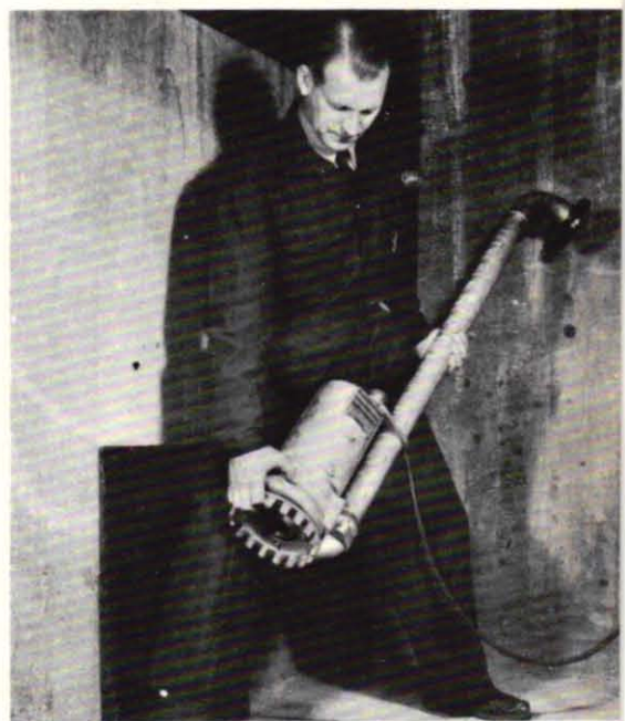
En ny grundvattenpump, som är helt sänkbar, vilket gör den oberoende av både gropdjup och takhöjd, har nyligen lanserats av AB Flygts Pumpar. Pumpaggregatet, som arbetar med en elektrisk motor, väger endast 32 kg och består av motordel, tätningsdel och pumpdel. Pris 685 kr.
