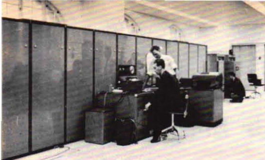
Matematikmaskinen "Mercury" har nyligen installerats i AB Atomenergis lokaler vid Tekniska Högskolan i Stockholm. Apparaten, som har hela 5 000 elektronrör, kan multiplicera två 9-siffriga tal på 300 mikrosekunder! (1 mikrosek. = 0,000001 sek.)
