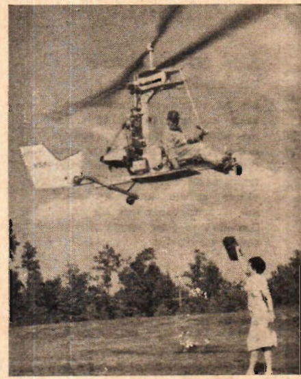
Den amerikanska helikopter- och drakflygkonstruktören Igor Benson visar här sin senaste helikopter. Den är världens minsta helikopter för privatbruk och kostar i USA ca 36 000 kr. Helikopterns marschfart ligger omkring 100 km/tim.
