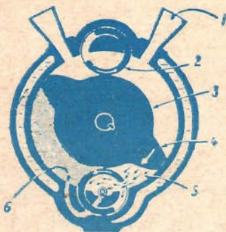
Baylin-motorn ovan var resultatet av en kanadensisk motorkonstruktörs strävanden och kom till 1946. Den presterade två arbetstakter per varv. 1 är luftintag, 2 roterande slid, 3 rotor, 4 tätningskammare, 5 utblåsningsslid, 6 överströmningskanal.
