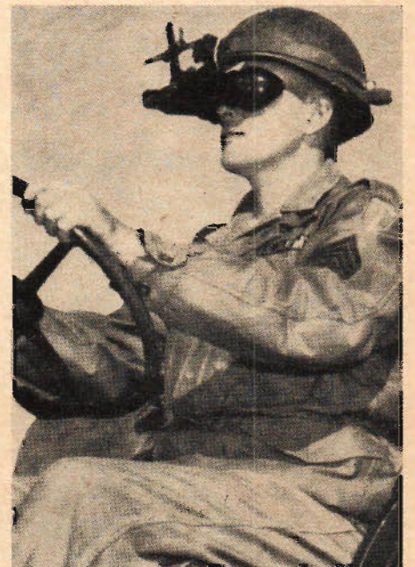
Infraröda "glasögon" är en annan praktisk uppfinning som hjälper den här jeepföraren att se nästan lika bra i kolsvart mörker som i dagsljus. Bilens strålkastare är försedd med infraröda filter.
