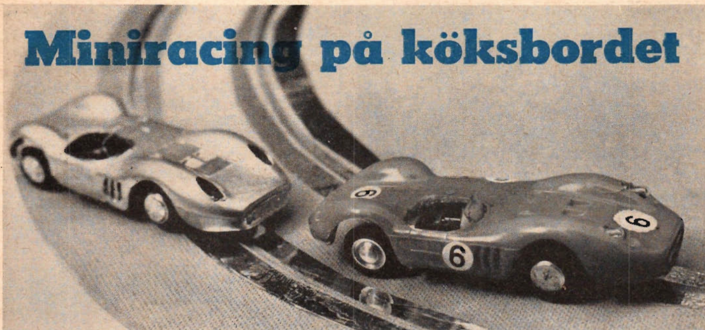
Två miniracers tar en kurva på Fredholms nya "TT-miniracerbana". Maserati-karosserna har hämtats från leksaksbilar och skalan är 1/40. Bilarna är försedda med den sjupoliga Terrier-motorn, som även kan byggas in i tränga karosser. Praktisladlar som ovan uppnås på banor med nedsänkta spår.
