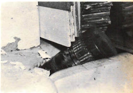
Här ovan har projektilen oskadad fångats upp av raketslädens inre. Bilden nedan visar baksidan av släden med den unika måltavlan. De fyra drivraketernas plats är hållarna på slädens sidor.
