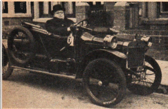
Bokstavligen talat för egen maskin körde fabriken grundare, Pelham Lee, omkring med denna 1911 års GKW. Svansmotorn utvecklade 9,2 hk.
