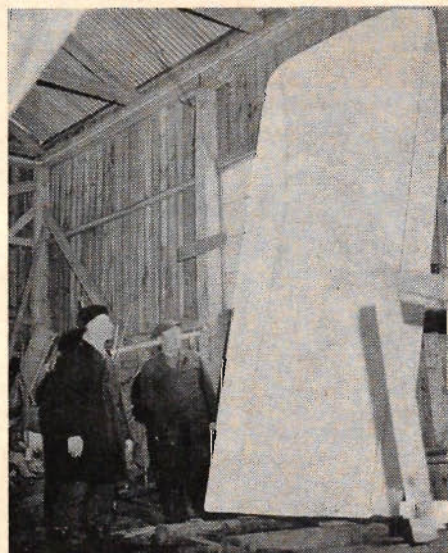
Hela skrovet är av plast, som visat sig vara det enda material som i längden tål de oerhörda påfrestningarna vid körning på skrovlig is, bland isflak och mot iskanterna. Här arbetar Bertil Johansson med ett av de första exemplaren.
