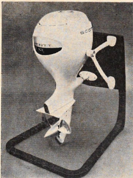
Den bulliga formen på Scotts senaste experimentmotor är betingad av utrymmesbehovet för de liggande, stjärnformigt placerade cylindrarna. Endast propellerpartiet är vridbart i sidled.
