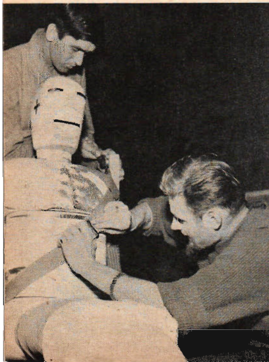
Ett hammarslag mot en sprint, ovan, utlöser den blixtnabba acceleration, som behövs för att på nio meter få upp vagnen med provdockan i 40 km/tim. Nedan visas hur bältet fästs före provet.
