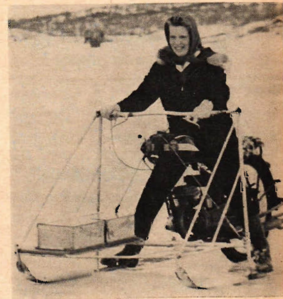
"Träskets" kraftigaste motorspark manövreras här lika snabbt som elegant av Birgit Eriksson. Sparken är gjord av en f. d. motorcykel och ett kraftigt stativ av stålror. Observera hur motorcykeln monterats med kraftiga wires. För bättre gång i snö har medarna ersatts med skidor.
