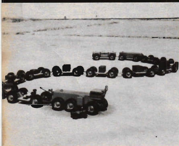
Enorma traktortåg av den typ som visas på bilden anses kunna klara jättetransporter i praktiskt taget väglös terräng, åkrar och snövidder. "Transportormen" har konstruerats bl. a. med tanke på militära behov. Än så länge existerar projektet enbart som modell, men enligt planerna skall drifningen ske turboelektriskt på alla 54 hjulen. Däcken blir 2,5 m höga och nära meterbredda. Den skalentliga modellen av jeepen bredvid visar transportbjässens enorma dimensioner.
