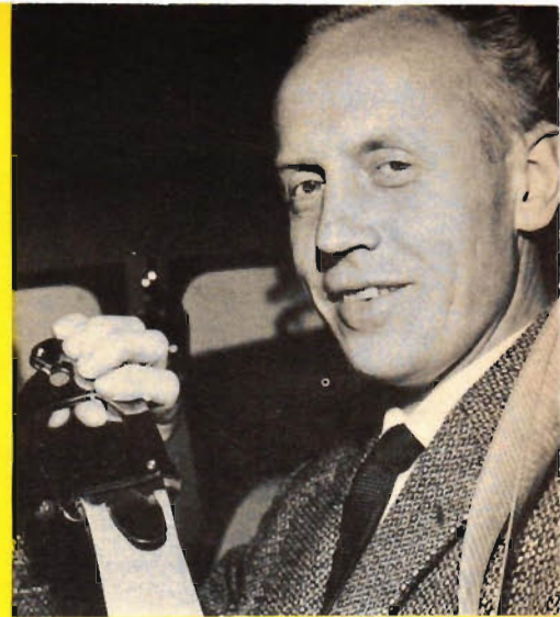
BERO säkerhetsbälte är en ny svensk konstruktion för vilken upphovsmannen, ingenjör Olav Rosenberg, Instrumentfirman Bero, i år belönats med Vermeil-medaljen vid den internationella uppfinnarmässan i Brüssel. Bältet är givetvis också provat och godkänt av ansvarig myndighet — Väg- och Vatten här hemma. Nyheten ligger först och främst i lösanordningen, som dels är mera "krockriktigt" utformad, dels kan manövreras med en hand. Löset och konstruktören ses på bilden ovan.
