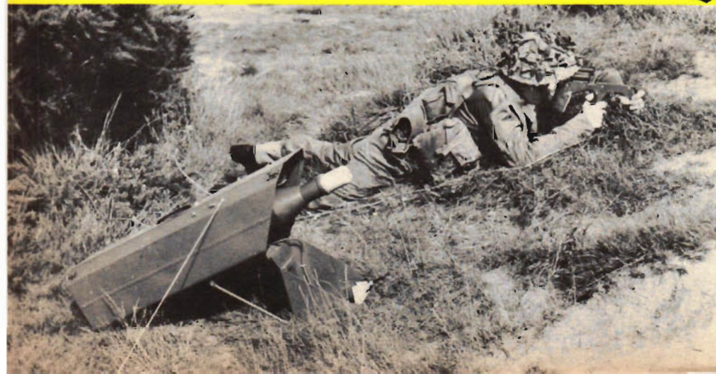
En enmansrobot för stridsvagnsbekämpning har konstruerats av Vickers Armstrong, England. Roboten är trådstyrd och ses på bilden klar för aktion mot mål på upp till 600 meters avstånd.
