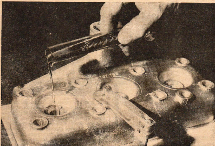
Ovannstående bild visar hur mätningen av topplockets kompressionskuper går till. Innan avhyllingen sker skall man kontrollera att somliga kuper innehåller samma volym. I trimmat skick skall kupoerna innehålla en volym av 37 cc. Detta mäter man lättast upp med hjälp av mätglas med tunn olja.
