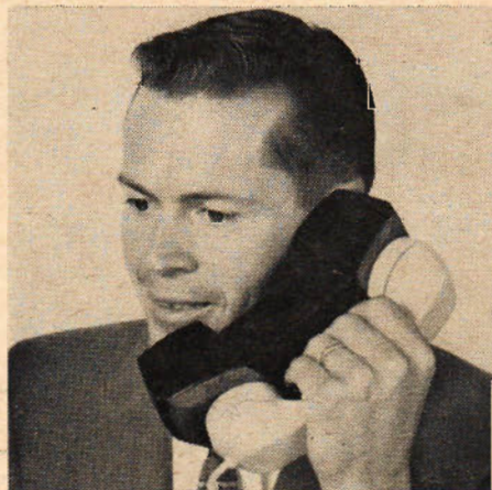
I stället för chiffer använder man numera apparater, som förvränger talet och förvandlar det till en serie obegripliga läten. Bara den rätta mottagaren, som har en speciell tillsats på telefonen, kan uppfatta samtalet. Tillsatsen ses här ovan.
