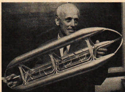
Den enda absolut asänkbara räddningsbåten kallar den tyske uppfinnaren Julius Reger sin konstruktion, som visas i modell på bilden. Tre flottörer svarar för flytkraften oberoende av läget i vattnet vid svår sjöhävning, påstår konstruktören.
