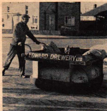
Skottkärran utan hjul är en engelsk nyhet, baserad på luftkuddeprincipen. Lyftkraften levereras av en encylindrig motor på 200 cc och lastförmågan är 200 kg. Serieproduktion i plast planeras.
