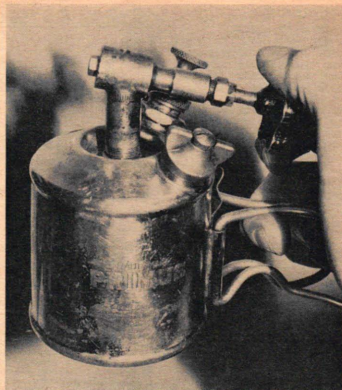
En vanlig blåslampa kan bli en utmärkt spruta för rostskyddsbehandling av bilen, för fotogentvättning av underredet samt för sprutning av chassilack.
