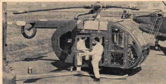
Den nya italienska helikoptern Fiat 7002 drivs med tryckluft. En turbinmotor alstrar tryckluften, som sedan slungas ut genom jetmunstycken i rotbladens spetsar. Både helikopter och turbinmotor har konstruerats av Fiats flygplansavdelning enligt uppdrag av det italienska försvarsministeriet.
