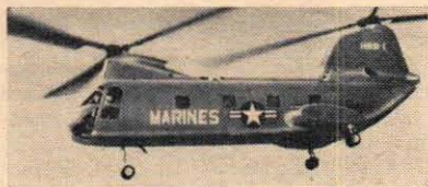
Boeing Vertol 107 kommer nu även i den militära versionen HRB-1. För att denna helikopter skall ta minsta möjliga plats ombord på hangarfartyg utrustas den med servomotor för snabb hopfällning av rotorn.
