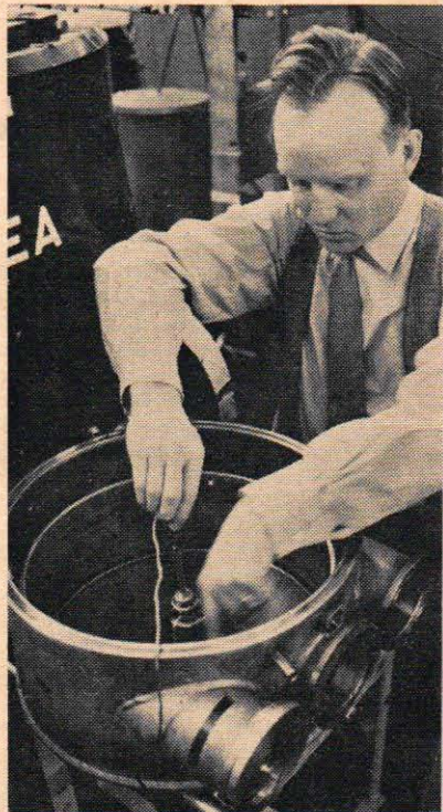
Artikelförfattaren, teknologie dr Lars Block, vid en isärtagen roterande plasmaapparat. Det har under experimenten visat sig att olika gaser roterar med olika hastigheter under samma premisser. Detta tyder på att gaser har sin egen karakteristiska rotationshastighet, vilket i så fall innebär att man funnit en ny naturlag.
