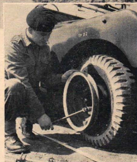
Speciella linhjul utanpå fälgarna är allt som behövs för att ett fordon skall kunna passera den unika bron. Men det gäller att hålla tungan rätt i mun under den spännande överfärden.
