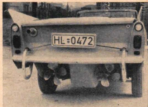
Amfibiebilen dubbla propellrar kopplas in med växelspaken och roterar med tredjedelen av motorns varvtal. Som marschfart uppges 10-12 km/tim, motsvarande sex-sju knop med sjömått mätt.
