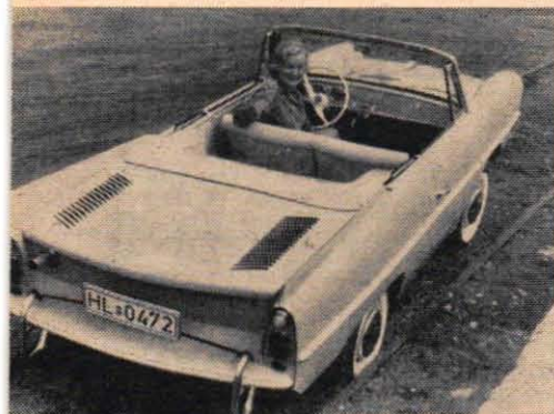
Sedd ur det här perspektivet förefaller Amphicar vara en tämligen traditionell cabriolet. Under motorhuvu bak döljer sig en 40 hk fyrcylindrig motor, köpt från Standard-fabrikerna i England.
