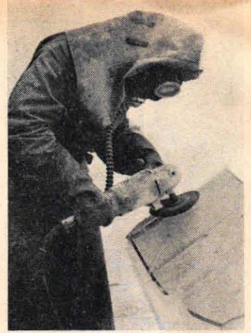
Det krävs andningsskydd och skyddsdräkt vid slipning av glasfiberarmerad plast (ovan). T.v. tre Monaritor med Varbergs fästning som bakgrund.
