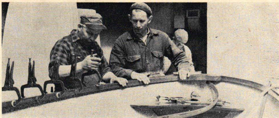
Relingslister och tofter är av mahogny på Monarita och här dras de basade och fernissade relingslisterna fast vid skrovet med hjälp av tvingar. Bilden nedan visar formarna till två kommande "storbyggen", en fartinspirerad vattenskidbåt och en kabinbåt (närmast kameran). Först bygger man en positiv form och sedan lamineras en negativ form på denna. Byggformen stagas upp med kraftiga lister.
