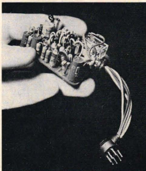
Rehaton mottagarbyggsatser är heltransistoriserade med tonfilter. Enkanalsmottagaren har fem transistorer och ett Grunerrelä. Måtten är 60x40x30 mm och vikten 40 g. Driftsspänning 6 V.
