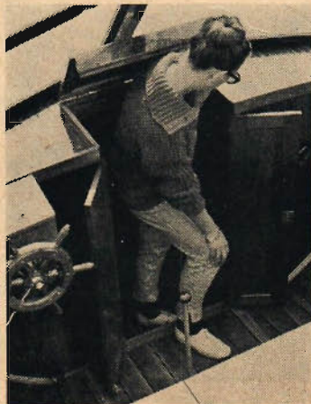
Ruffdörren är kombinerad med en "taklucka" som underlättar passagen. Samtliga durkar i båten är utförda i mahogny.
