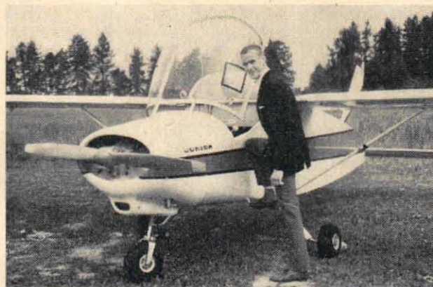
MFI Junior är mindre än konkurrenterna. Spännvidd 7,4 m, längd 5,6 m och höjd 1,9 m. Planet har två sittplatser och tomvikten är 300 kg. 244 kg nyttig last kan det ta. Med en 100 hk Continental-motor ger planet marschfarten 240 km/tim. Räckvidden är 900 km. Pris 32 200 kr.
