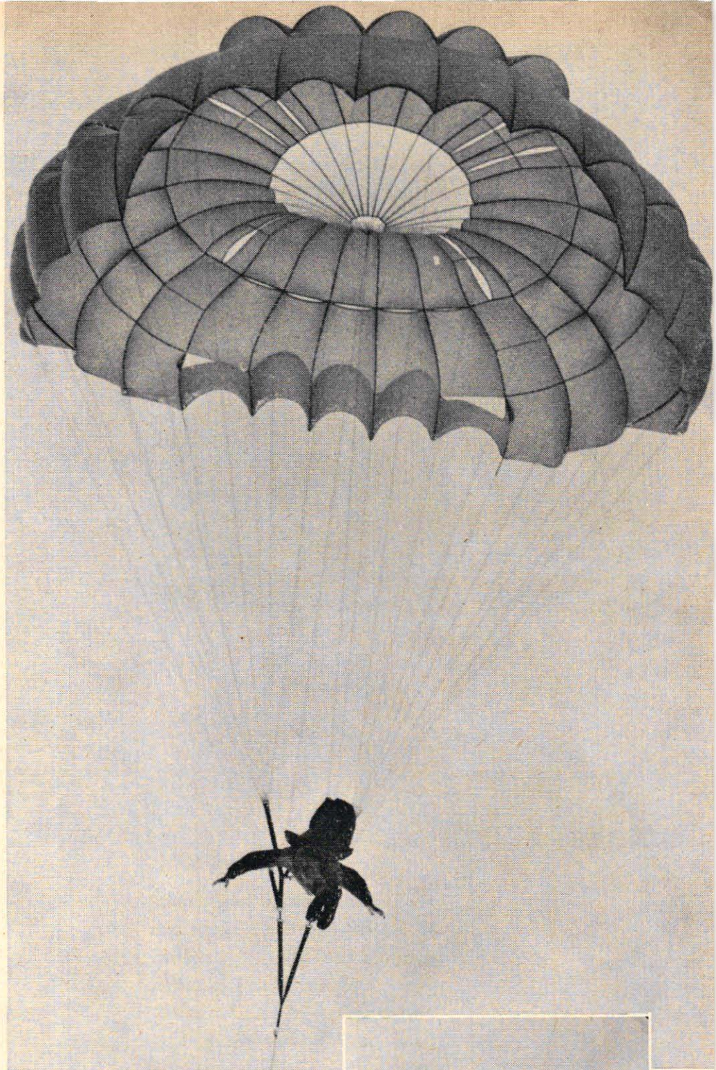
Ovan: Armarna rakt ut är tecknet till medhjälparen på lastbilen att koppla loss linan. När så skett bär det av neråt för hopparen. Fallhastigheten är dock bara ca 4 m/sek — ungefär hälften så hög som fallhastigheten för en vanlig skärm.
