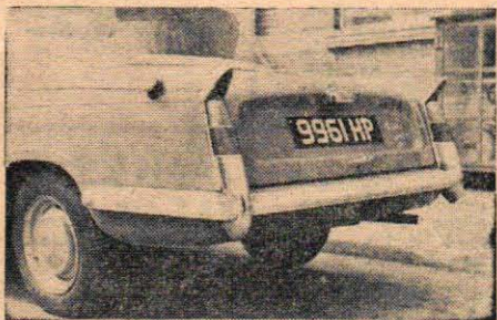
Originell detalj: stötdämparna är klädda med vitt gummi både fram och bak. De vertikala avbärarna i "hörnen" är dock av förkromat stål.
