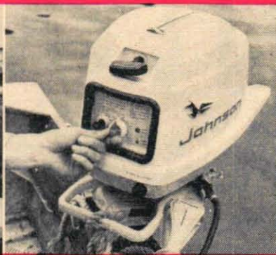
Motorn har ställbart tomgångs- och huvudmunstycke på "instrumentbräda".
