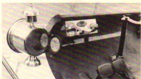
"Instrumentbrädan" är den minsta möjliga, bara en liten plåtpanel med två reglage och växelspak. Observera den blankpolerade strålkastaren.
