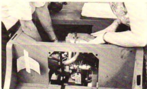
Ett bilbygge för hela familjen. Ovan installeras spakstyrningen, nedan sätts den lilla motorn på plats i ramen. T.h. de originella hjulen i trä.
