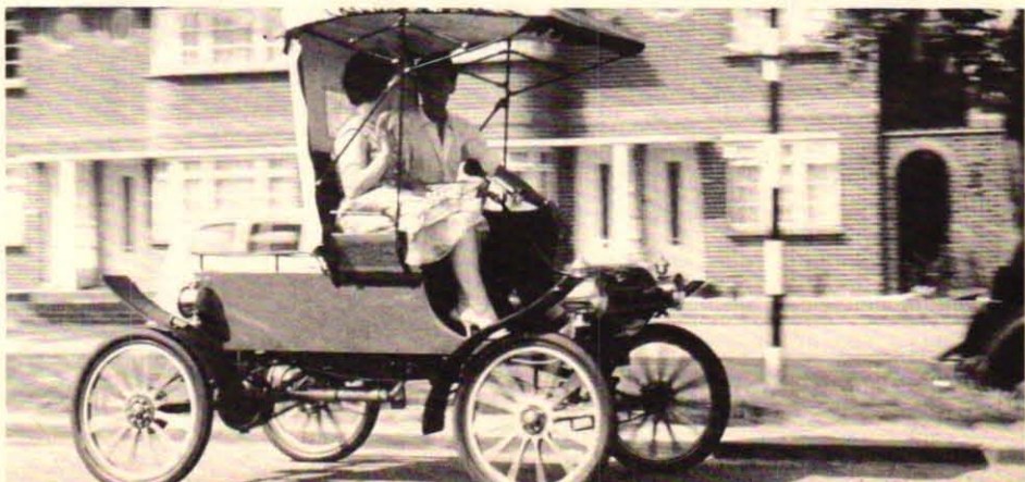
Surrey är kedjedriven via ett kuggghjul på bakaxeln. På kedjan sitter ett extra kuggghjul för hastighetsmätaren. Vagnen har som synes bladfjädring.
