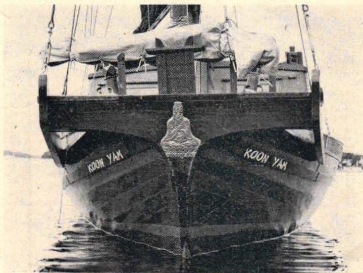
Djonken är en robust båt. Bordläggningen av av 1 1/4 tums teak medan trävirket under vattenlinjen är yacal. Båten är också ganska tung, cirka fem ton. Lägga märke till det ovanliga utförandet av bogen med bred bryggkonstruktion.
