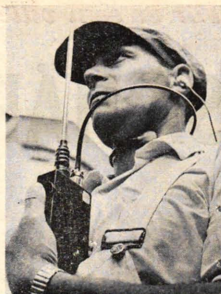
SAAB "MS 12" är en nyhet från SAAB Electronics i Stockholm. Det är en lätt apparat av walkie-talkie-typ, vikt 400 gram, med vattentätt hölje och infällbar teleskopantenn. Priset är inte fastställt, men beräknas bli omkring 1 000 kr per apparat.
