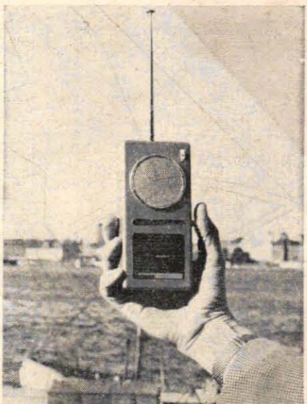
Telecon, typ GT-201-B, är en s.k. walkie-talkie med 1 milliwatts effekt och en räckvidd av ca 1,5 km. Apparaten, som väger 410 gram, är heltransistoriserad och typgodkänd av Telestyrelsen. Pris 320 kr pr apparat, generalagent AB Ferrofon.
