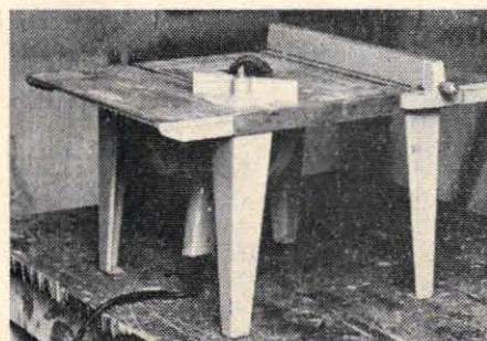
På denna bild visas handcirkelsågen monterad i bänkstället, som är utökat med två sidostycken. Sågklingan har en diameter av 152 mm.
