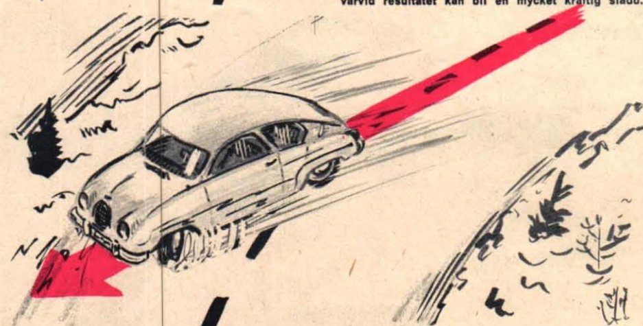
Den framhjulsdrivna vagnen tenderar när drivhjul vid hård kurvtagning i halka förlora sitt grepp mot vägbanan att gå rakt fram i tangentens riktning.
