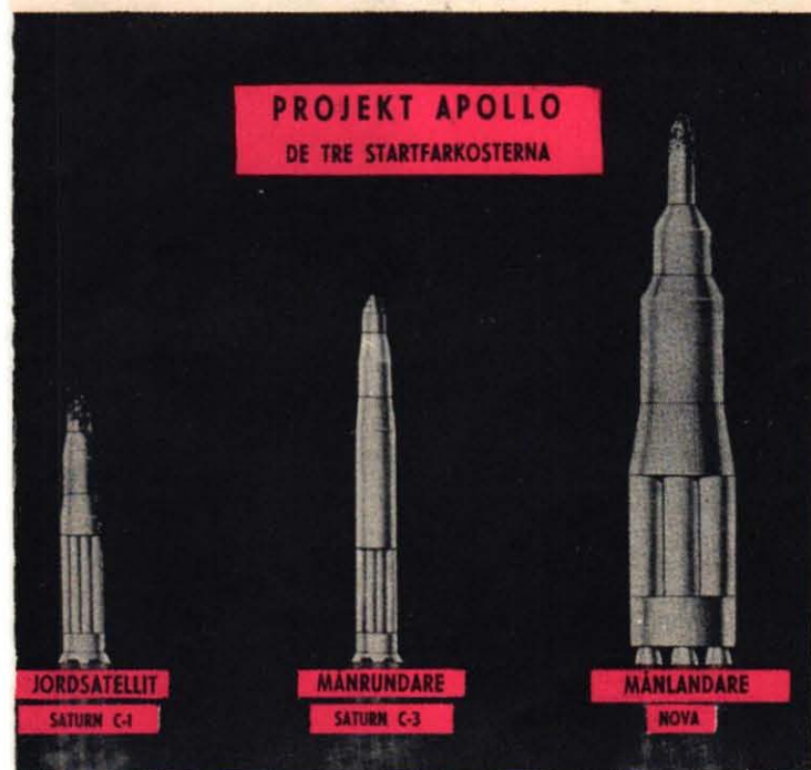
Startfarkoster: För Apollo-A avses C-1-versionen av Saturnraketen, för Apollo-B Saturn C-3 och för Apollo-C den projekterade jätteraketen Nova.
