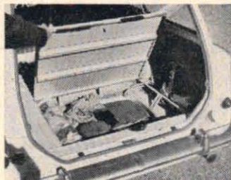
Opel Caravan har liksom Taunus 17 M ett extra stuvningsutrymme ca 9 cm under lastrumsgolvet. I vanliga fall täcks golvet i detta utrymme av en matta, som emellertid på bilden här är borttagen. Bra plats för stövlar, verktyg, bogserlina, domkraft m.m.
