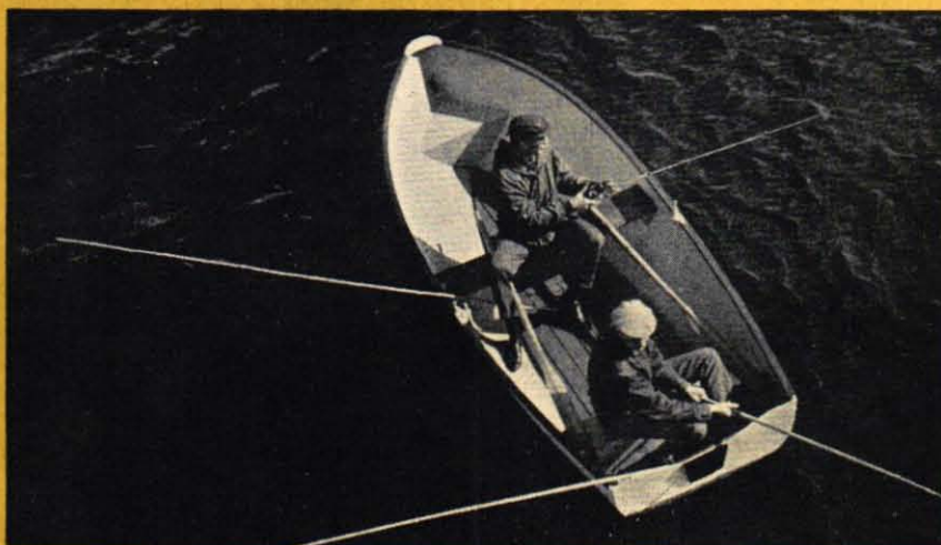
Sjöduglig, osänkbar sportfiskebåt av plast på 4x1,5 m, lagom prydd med mahogny för att göra ett båtmässigt intryck — kostar omkring 1 500 kronor och gör 7 knop med 6 hk snurra.
