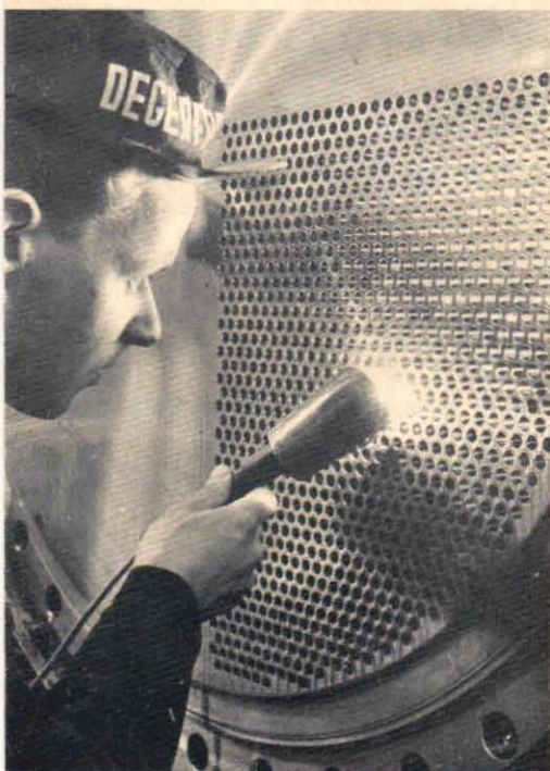
4 000 hål skall borraras i denna tubplatta till en av värmeväxlarna för reaktorn. Plattan består av 150 mm tjockt rostfritt stål och väger 1,5 ton. Här kontrolleras att precisionen håller — diameter-toleransen på de 9,8 mm stora hålen är endast plusminus 0,05 mm. Rakethtolerans: 0,15 mm.
