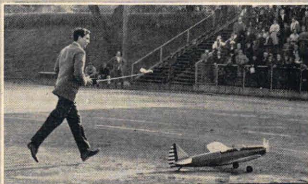
Publiken höll andan medan Sten-Åke Grahn visade radiokontroll i den högre skolan. Med en tio kanalers Orbit-anläggning styrde han perfekt den stora modellen av en Fairchild PT 19 — spännvidden var 1,8 m — och avslutade uppvisningen med perfekt landning vid läktaren.
