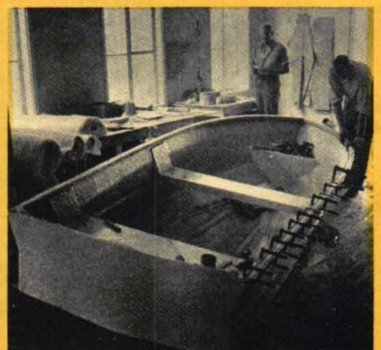
Stryktålig snabb plastbåt. Måtten är 4,25x1,7 m och priset ca 2 000 kr. En snurra på 40 hk ger omkring 28 knop.
