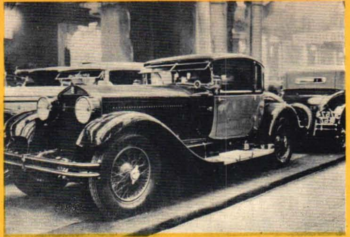
VINTAGE-VAGN. Isotta Fraschini modell 1928, typ 8B, hade en 8-cylindrig motor på 76 hk vid 2 200 v/min som gav vagnen en fart av ca 150 km/tim. Den eleganta kupékarossen byggdes av karoskräddaren Cesare Sala i Milano.
