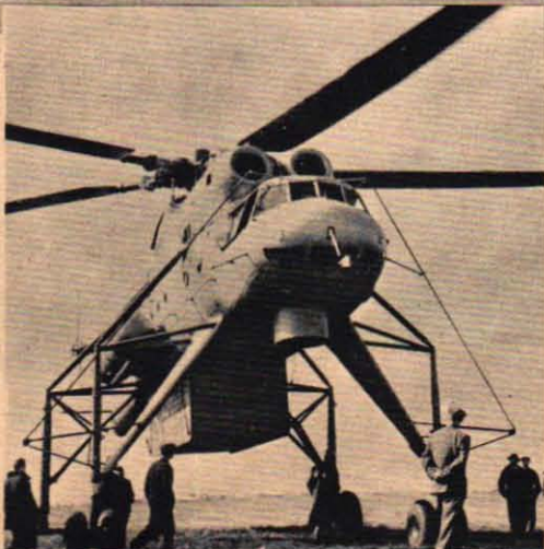
Världens största helikopter — Mikhail Mil-6 — på övre bilden med Gagarins rymdskepp Vostok II som hängande last. På denna bild är helikoptern utrustad med ett normalt landställ och saknar de stora yttre bränsletankar, av vilka den ena syns efter kroppssidans på den undre bilden. Med ett specialkonstruerat landställ, utformat för att stor hängande last skall kunna bäras under flygkroppen, påminner Mil-6 om en fantastisk jättegäshoppa (bilden t. v.).
