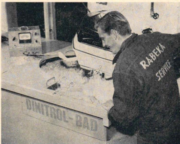
Sverige torde vara först i världen med rostskyddsbehandling av båtmotorer. AB Tikamin i Hälmingborg har arbetat ut en speciell procedur för arbetet, som delvis grundar sig på ML-metoden. På bilden körs en motor i ett rostskyddsbad.
