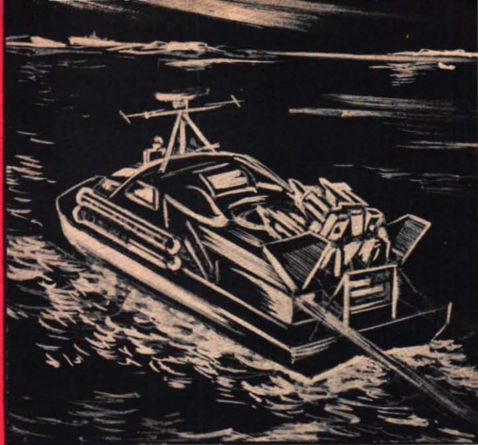
En markeffektfarkost, Mefa, kan bli en utomordentlig lösning när det gäller skärgårdskrigföring. Den kan ta sig fram när isen varken bär eller bryter och kan operera utan att ta hänsyn till mineringar. Dess beväpning kan utgöras av exempelvis torpeder och lätta robotar.
