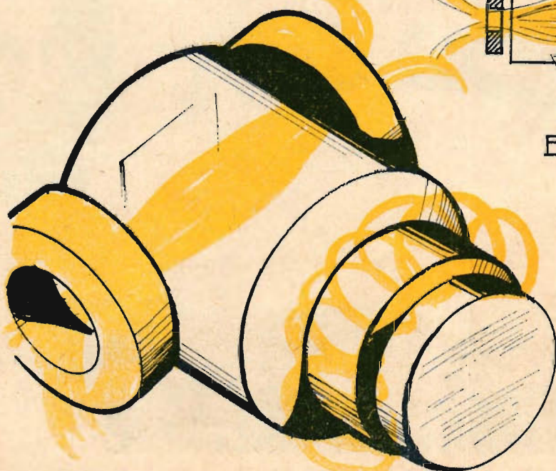
Teckningen visar hur magnetpolarna är placerade på vakuumbehållaren i vilken elektroner rör sig. Spolen i den smala änden innesluter linsen.
