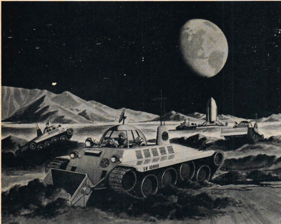
Så här har teknikerna hos Martin Company's Space System Division i USA tänkt sig att ett universalfordon för färder på månen skall se ut. Apparaten drivs med flytande väte via turbiner, generatorer och elmotorer och bränslet kan "laddas" upp i en stationär atomreaktor.
