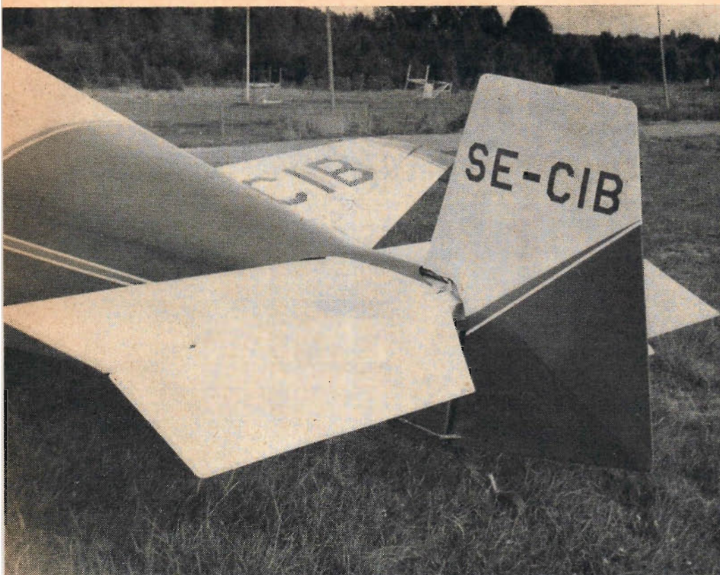
Jodel Club har ingen fena utan sidorodret är utformat som pendelroder. Finishen på denna Jodel var mycket god och man förstår mycket snart att ett hembygge som detta krävt ett imponerande antal arbetstimmar.
