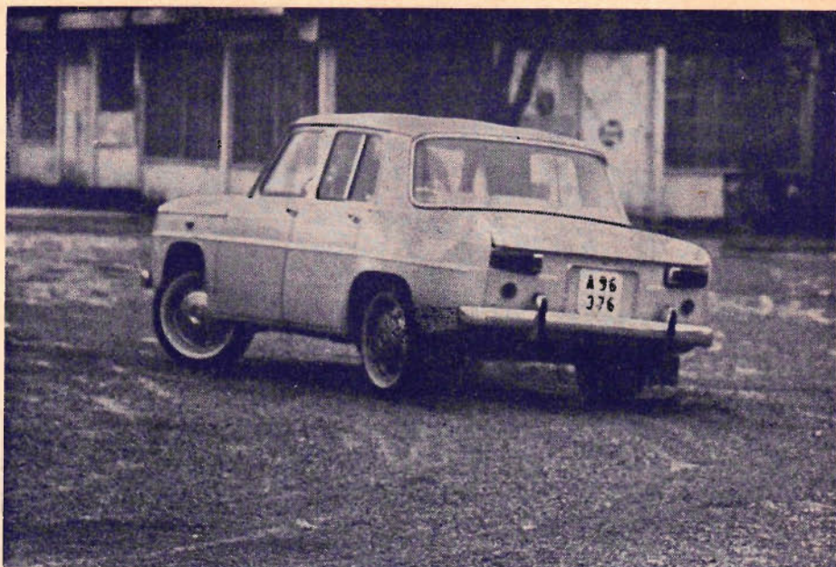
R 8 har blivit en trevlig och pigg bil. Utvändigt är den en typisk representant för den nu så populära två-koppsstilen. De fyra dörrarna som öppnas i praktiskt taget rät vinkel medger bekväm i- och urstigning. Lägga märke till de rejält tilltagna baklyktorna. Vagnen lämpar sig bra för stadskörning, trots den osynkade ettan.
