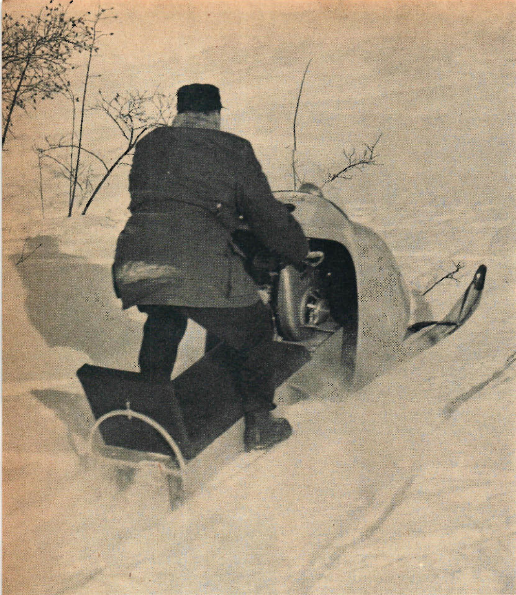
Snöskotern är lättare att köra än en moped, då den saknar koppling. Drar man på för fullt gör åkdonet omkring 40 km/tim, och det fordras en hel del teknik för att kunna klara tvära kurvor utan att välta.
