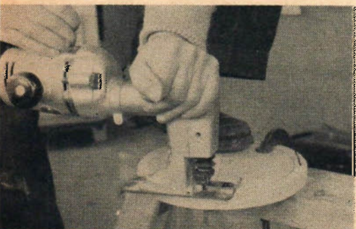
Här skärs en ganska snäv cirkel med en kontursåg. Det är en Black & Decker-såg och arbetsstycket stagas upp dels med en stor tvång, dels med en fot.
