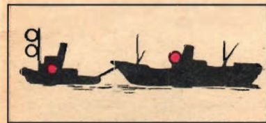
En bogserbåt med släp som är kortare än 183 m för sidolaternor, akterlantern och två topplantern placerade över varandra.
