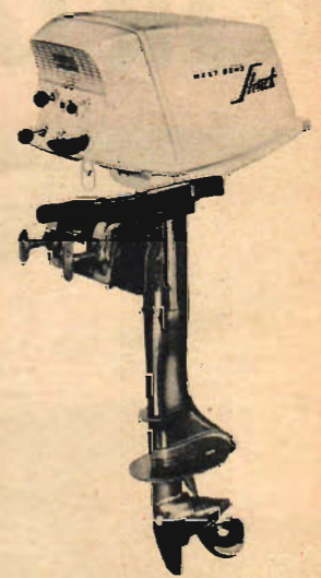
West Bend Shark ger 7,5 hk vid 4 000 v/min. Det är en tvåcylindrig motor på 196 cc. Denna motor väger 21 kg.
