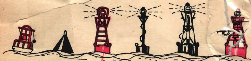
Vid grund i öppna sjön ligger röd boj syd- eller västvärt om grund. Svart boj ligger nordvärt om grund medan svart boj med vitt bälte ligger östvärt om grundet. Bojarna är fr. v. klockboj, ljudboj, två typer lysbojar, en kombinerad lys- och ljudboj samt en kombinerad lys- och klockboj. Placeringen anges i sjökortet.
