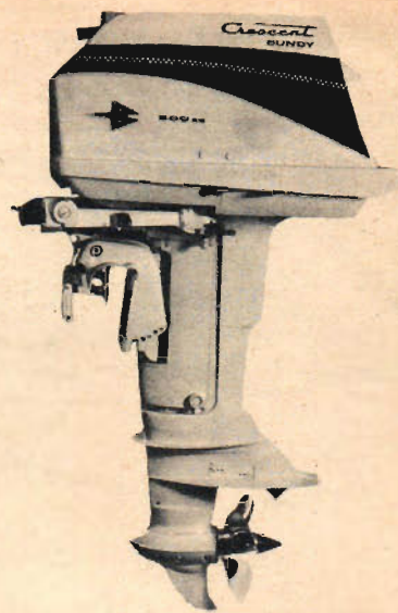
Crescents största bruksmotor är Bundy, en tvåcylindrig motor på 500 cc som ger 30 hk vid 5 200 v/min. Vikt 46 kg.
