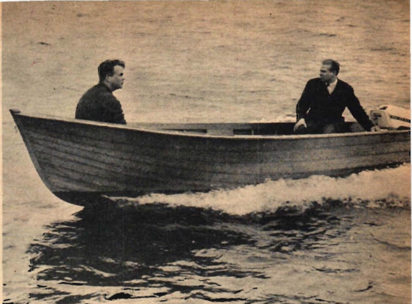
Lill-kobben ingår i AB Gösta Bergs serie av utombordsmotorbåtar. Den är klänkbyggd i mahogny. Längden är 4,60 m och bredden är 1,75 m. Den är en praktisk båt för t. ex. sommarnöjet, för fisketurer osv. Båten har säte i stäven, två roddtofter samt två rejäla, låsbara hurtsar. Priset på Lill-kobben är 1 750 kr.
