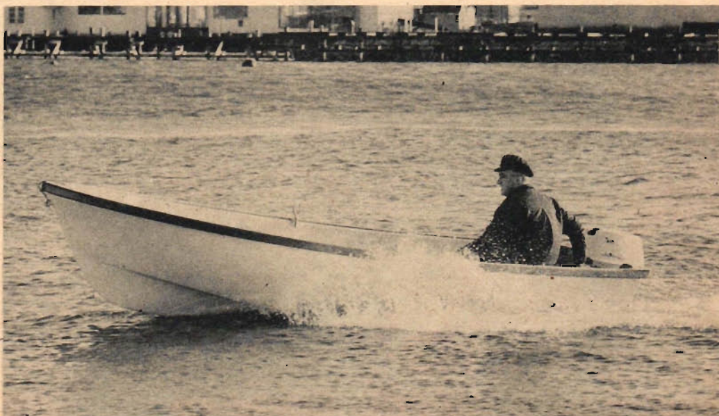
Roddåten Snurrån kommer från Malmö Flygindustri och skrovet är tillverkat av glasfiberplast. Båten är osänkbar genom inbyggda flyttankar som är så konstruerade att de även tjänstgör som bottenförstuvning. Snurrån har ritats av Olle Enderlein och dimensionerna är 4,25 m x 1,50 m. Båten väger ca 130 kg och kan jämpligen utrustas med utombordsmotor på mellan 3 och 8 hk. I första hand är båten tänkt som familjebåt för bad och fiske. Priset är 1 760 kronor.
