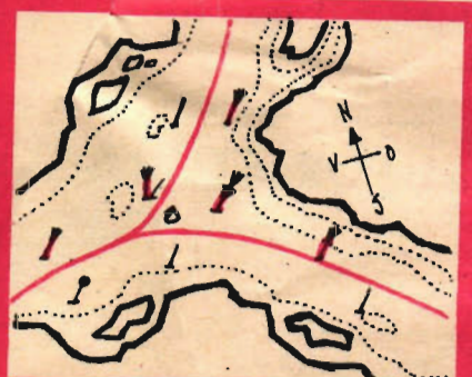
Vrakutprickning kan ske med vrakfyrskepp (t. v.) varvid rånocken med en ballong är närmast vraket. Vraklysbojen är grön liksom samtliga andra vrakmärken. Enkelflaggarna placeras syd och väst från vraket medan dubbellaggarna placeras nord och ost från vraket. "Gamla" vrak anges med särskilt tecken i sjökortet.
