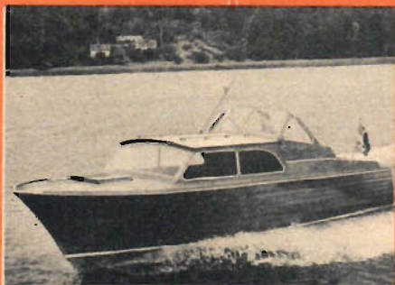
Saxaren byggs av Gamleby Yachtvarv och är en klinkbyggd mahognybåt med Penta BB 70 inombordsmotor. Måtten är 7,75x2,45 m. Med lanternor, dynor, elektrisk lämpump etc. kostar Saxaren 32 500 kr.
