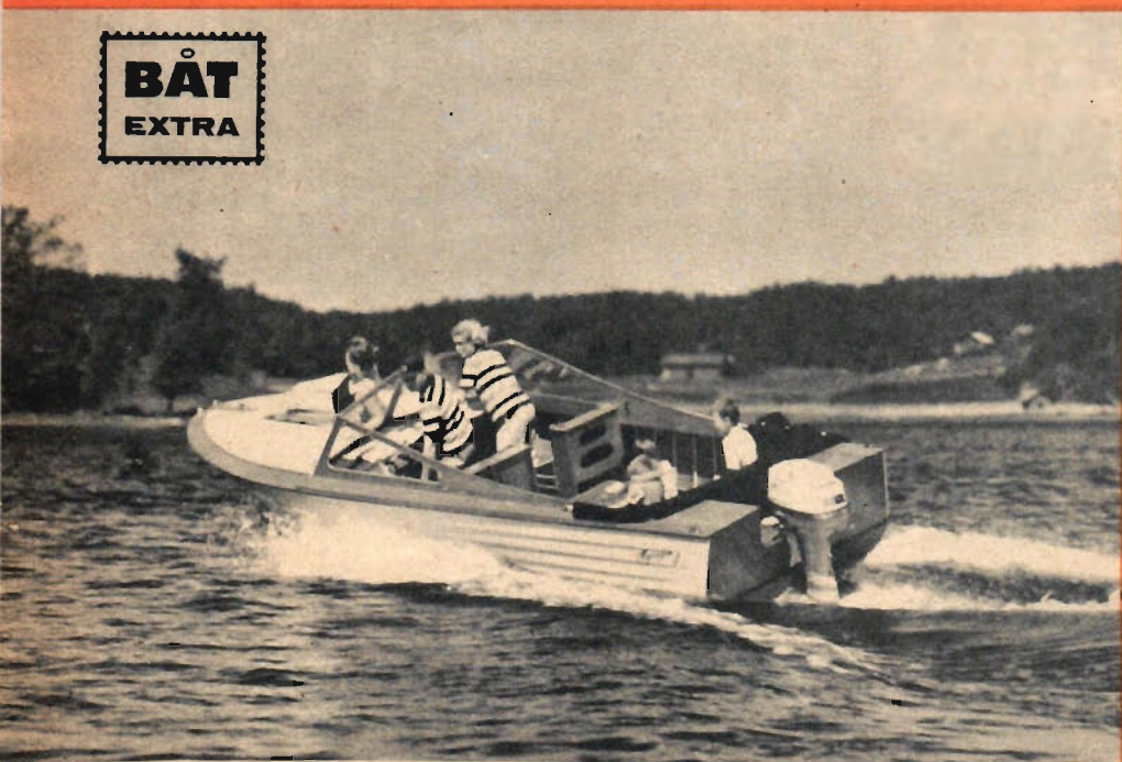
Mysingen 4 är en ruffad semesterbåt från Stockholms Motorcentrum. Två koier finns i ruffen och stövsutrymmena är goda överlag. Båten är klinkbyggd i furu och mahogny och dimensionerna är 6,40x2,40 m. Denna kabinbåt är avsedd för utombordsmotorer mellan 18-100 hk och fartregistret ligger mellan 12 och 28 knop. Priset för själva båten är 8 750 kr, vartill dock naturligtvis kommer utombordsmotor, fjärreglage osv.
