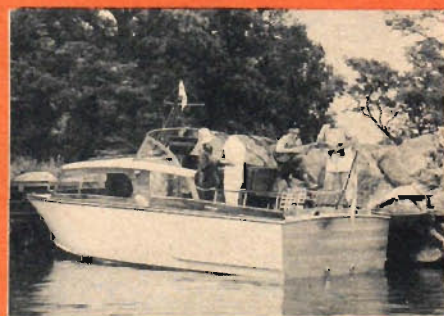
Motorkryssaren Storö tillhör de exklusivare seriebyggna. Den lanseras av AB Gösta Berg, är krävellbyggd i mahogny och mäter 8,55x2,80 m. Har fyra kojplatser och två Penta BB 100. Pris 54 300 kr.
