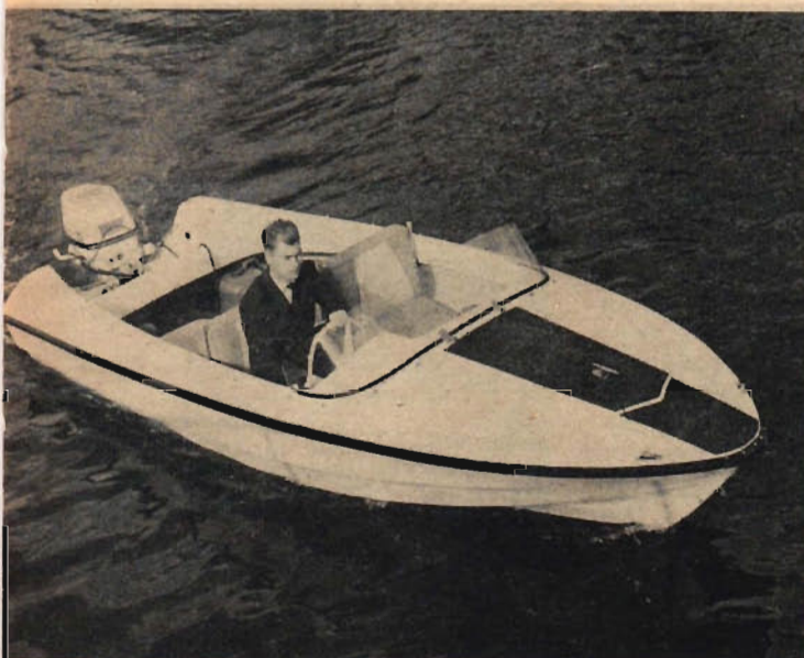
Flygfisken byggs av Malmö Flygindustri och har konstruerats av Olle Enderlein. Båten är tillverkad av glasfiberplast och har långsgående förstyrningar. Fenorna är skumplastfyllda och tjänar därför som flytkroppar. Längden är 3,40 m och bredden 1,45 m. Lämplig motorstyrka är mellan 18 och 40 hk. Priset är 2 850 kr.
