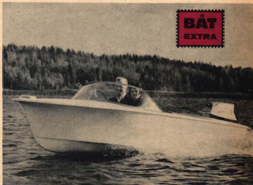
AB Skagerviks Industrier bygger också en mindre version av Essi-Sport, nämligen Essi-Sprint. Denna båt mäter 3,85x1,65 m. Även denna båt har de långsgående stegen, som ger en synnerligen mjuk gång. Essi-Sprint är liksom den större versionen utrustad med flyttankar. Priset på Essi-Sprint är 3 650 kr.
