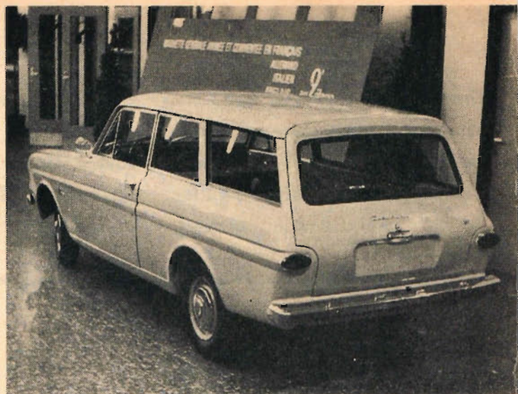
Taunus 12 M Combi har en karakteristiskt utformad baklucka, men är i övrigt nästan helt identisk med Cortinas kombiversion vad lastutrymmet beträffar. Bakluckan fälls uppåt och kommer bra ur vägen vid all l- och urlastning.
