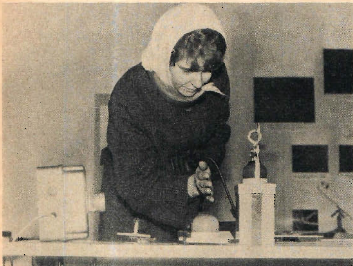
Linnéa Hammar demonstrerar ett transistoriserat blinkdon, konstruerat av Christer Falkenström, Göteborg. Det har en fotocell för automatisk släckning och tändning.
