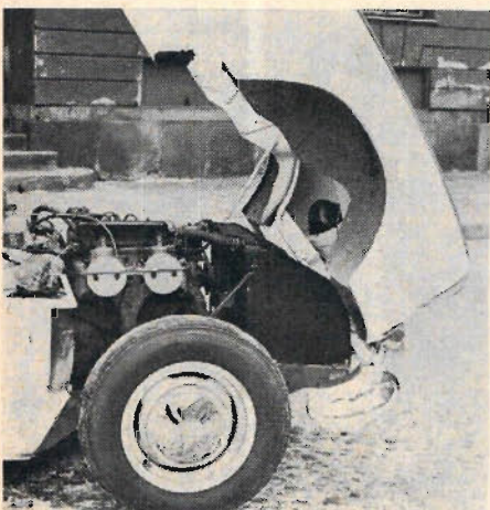
När vi stjärper fram motorhuven, finner vi ett över-skådligt och lätt åtkomligt motorrum. Den 70 hästar starka motorn andas genom SU-förgasare.
