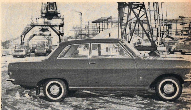
Karakteristiskt för den nya modellen är ett midjeveck som löper utefter hela sidan. Det bidrar inte bara till att göra exteriören snyggare, utan ökar också den inre bredden. Vagnen har stora rutor, som medger god sikt åt alla håll.
