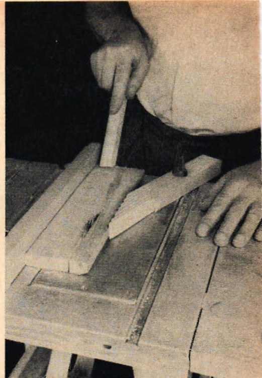
En hemgjord, fjädrande anordning används här för att hålla arbetsstycket mot klyvanhållet. För säkerhets skull matas arbetsstycket fram med en ribba.
