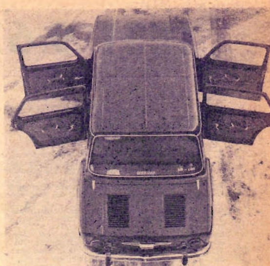
De fyra dörrarna öppnas i stor vinkel mot karossidan. Det gör att det är lätt att stiga i och ur vagnen. Till komforten bidrar också bekväma säten.
