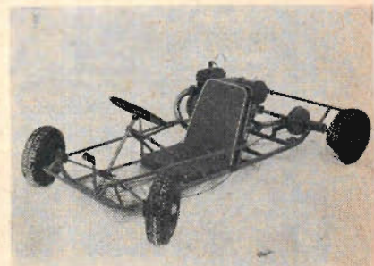
Ovan en Bantam som är utrustad med en 175 cc Ilo-motor. Chassit lämpar sig utmärkt även för mindre motorer. Färdig vagn utan motor kostar 950 kr.
