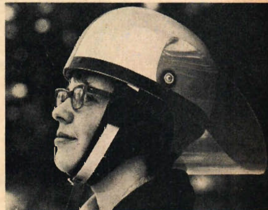
Om ett visir skall påmonteras är det bäst att anlita fackman. Annars kan det gå som på bilden ovan. Visiret är felmonterat och åker ned i nacken. I ett sådant fall kan det lätt tillfoga bäraren skador.
