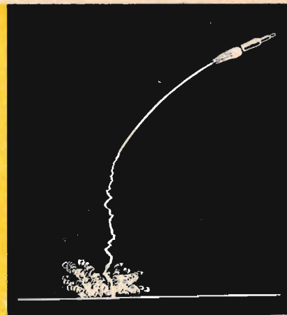
Fig 8. Teckningen visar hur den amerikanska Minuteman-raketen råkade i dynamisk instabilitet under starten vid den första lyckade uppskjutningen.
