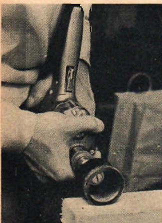
Slipcylindern används här som frihandsslip. Det gäller som synes att hålla maskinen i ett stadigt grepp.
