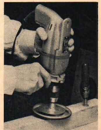
Rondellen i arbete. Det gäller att hålla rätt vinkel hela tiden och detta underlättas om maskinen har stödhandtag.
