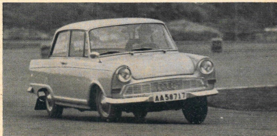
F 12 är en mycket pigg bil. Den är utrustad med en 45 hästars tvåtaktsmotor. Växellådan är helsynkroniserad med fyra framåtlägen. Accelerationssiffrorna är hyfsade: 0—80 km/tim tar omkring 12 sekunder.
