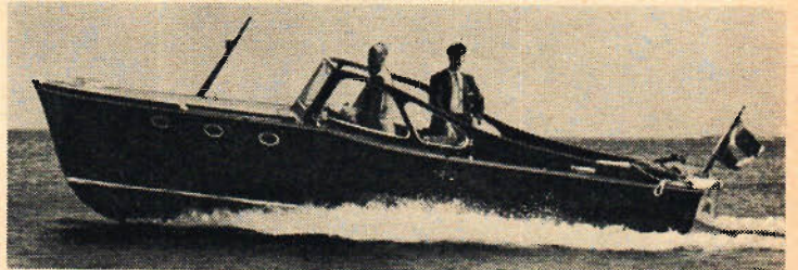
SOLO 7,25×2,25 m. Ruffbåt med 2 kojplatser och pentry. Motor: Volvo Penta BB 70, fart c:a 16 knop. SOLO finns också i byggsats.
