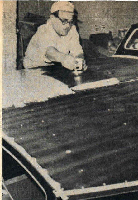
Kabintaket stryks här med Polygrund-primern. Efter två primerstrykningar sker en avslutande strykning med Interlux 708-lackfärg.
