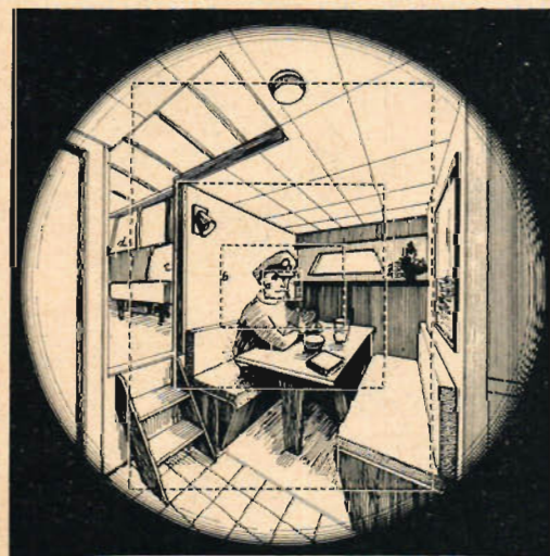
Fig 5. Ett objektivet med mycket stor bildvinkel ger en förvrängd bild. Den effektiva bildvinkeln minskar dock om formatet minskar. Här har maxiformatet 9x12 cm lagts in (streckade linjen d). För mindre format, 6x6 cm (c), 24x36 mm (b) eller 16 mm bildruta minskar deformationen men också det område som kan tas med på bilden.
