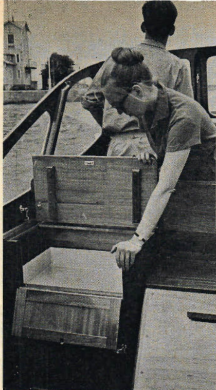
Bakom förarstolens rygg finns ett pentryskåp. Här finns god plats för ett tvålågigt gasolkök. Även ett skåp för köksutensilierna ingår i utrustningen.
