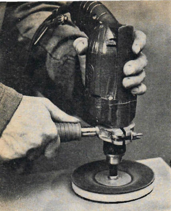
Slipprondellen — Universaldisk nr 32 — visas här i arbete. Lägga även märke till det nya och förbättrade stödhandtaget till bormaskinen.
