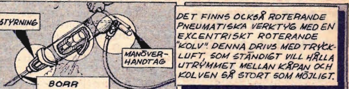
DET FINNS OCKSÅ RÖTERANDE PNEUMATISKA VERKTYG MED EN EXCENTRISKT RÖTERANDE "KOLV" DENNA DRIVS MED TRYCKLUFT, SOM STÄNDIGT VILL HÅLLA UTRYMMET MELLAN KÄPPAN OCH KOLVEN BÅR STORT SOM MÖJLIGT.
