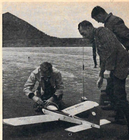
Jerry Nelson, USA, startar sin "Cumulus" — en egen konstruktion avsedd för proportionalstyrning. Modellen har extremt lång bakkropp.
