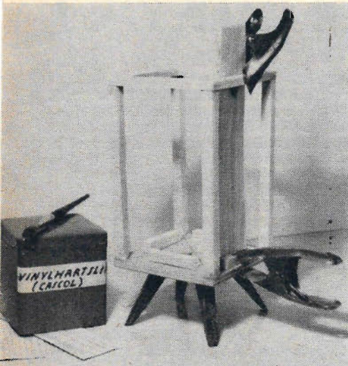
Bilden visar hur man limmar fast innerfaneren med hjälp av klossar och klämmor.
