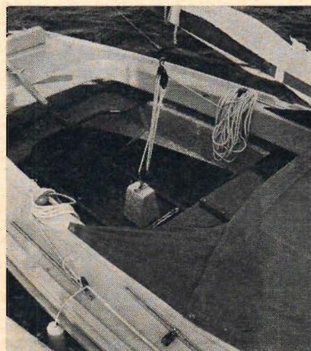
Sittrummet är rymligt på Avanti och det finns goda stuvningsutrymmen bl a under skamdäcket. Ett kapell som finns att få som extra tillbehör gör att båten kan användas även för övernattnig.
