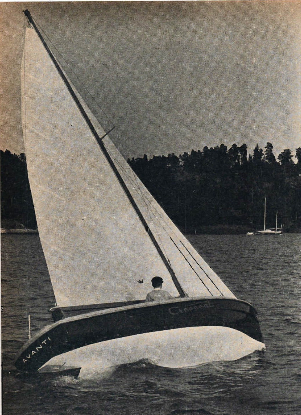
Avanti har mastheadrigg och mast i fiberglas. Båten är helt byggd i plast med durk av mahogny och fotlister av teak. Akterns utformning ger snabb gång genom att vattnet lättare släpper och att baksug förhindras.
