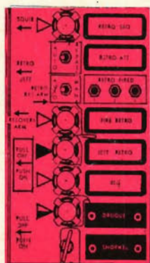
Teckningen t v visar hela instrumentbrädan i "Faith 7". T h en uppförstoring av den med rött markerade delen med knappar och varningslampor som Cooper använde för manuell styrning av rymdskippet när det helautomatiska systemet strejkade under återinträdet i atmosfären.
