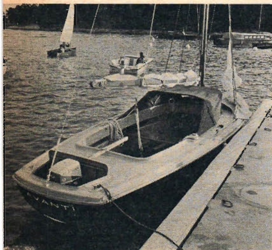
Längst akterut finns inbyggd motorbrunn för en 4 hk utombordsmotor. Motorn är stuvbar tvärskepps i motorbrunnen, som också är låsbar. Båten gör sex knop med Crescenta fyrahästarmotor.
