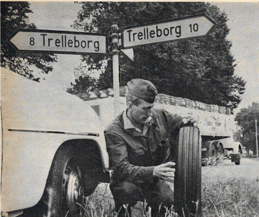
Sån't här tar på däcken, men krängningsproven ger värdefulla uppgifter till ledning för konstruktion och tillverkning av däck.
