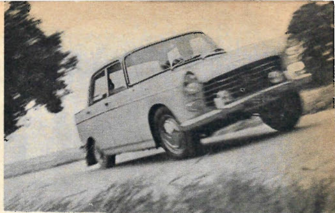
Sån't här tar på däcken, men krängningsproven ger värdefulla uppgifter till ledning för konstruktion och tillverkning av däck.
