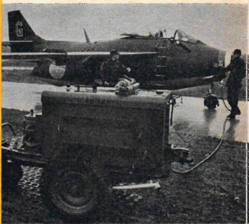
I uppställningsfickorna står i 29:orna klara till insats. Startaggregat och tankvagnar är framkörda till uppställningsplatsen och flygplanet kan göras startklart på några få minuter.
