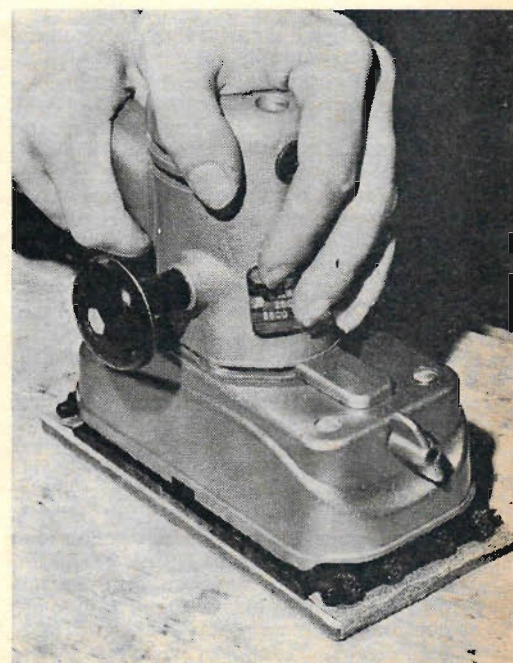
Putstillsatsens bottenplatta är 90x180 mm. Bilden visar det bästa greppet vid putsning. Knoppen på maskinen är löstagbar och kan flyttas.
