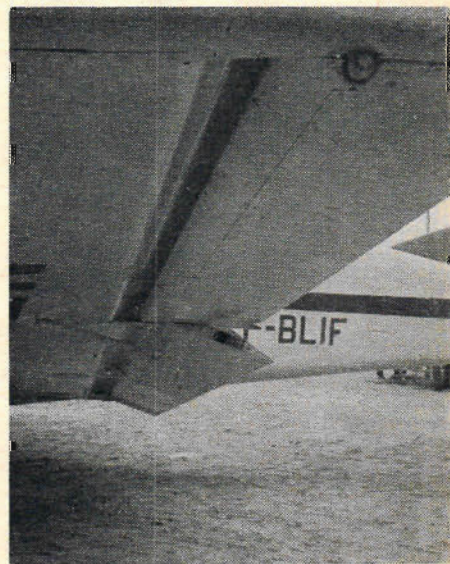
Vingklaffarna fälls bara ner 20 grader men får ändå stor lyftverkan genom att de är av fowlertyp. De upptar två tredjedelar av vingbakkanten.
