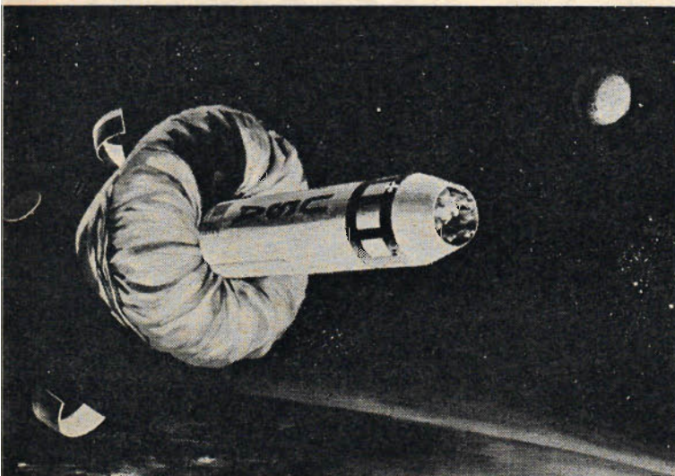
När raketten väl kommit in i kretsbanan och atomraketten separerat, fälls skyddsplåtarna till den kammare, där "jätteblåsorna" förvaras. Den nedre, koniskt formade behållaren fylls nu med gas och börjar långsamt ta form.
