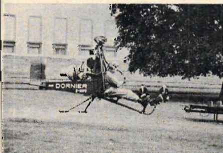
6 Manövreringsförmågan är mycket god med bl a snäva svängar. Här nödlandar helikoptern efter simulerat motorstopp.
