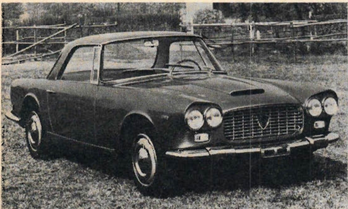
Lancia Flaminia 2,5 i tillverkas i följande versioner: Sedan, Coupé 3 B, GT 3 C 2 + 2, GT 3 C och Cabriolet och Sport 3 C. Hästkraftantalet varierar mellan 110 för Sedan och 140 för GT. På bilden Flaminia Gran Turismo 3 C 2 + 2.
