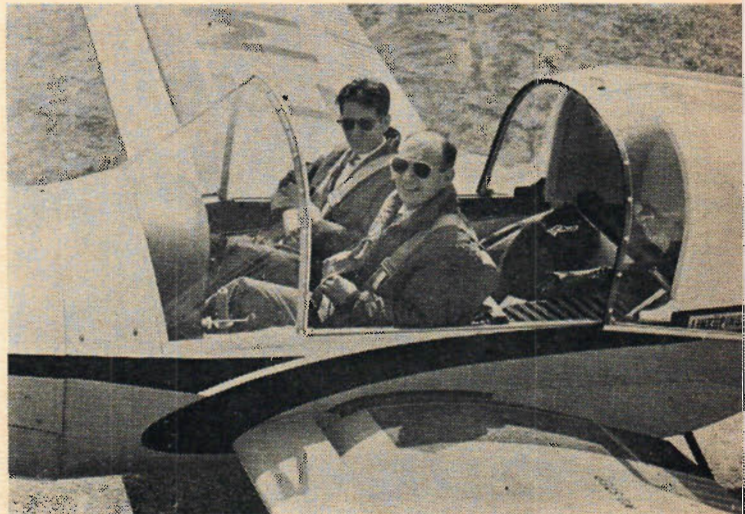
Trots att Rallye väl rymmer fyra personer är den tresitsig. Vissa förstärkningar kommer att göras i flygkroppen för att typen skall godkännas som fyrsitsig.
