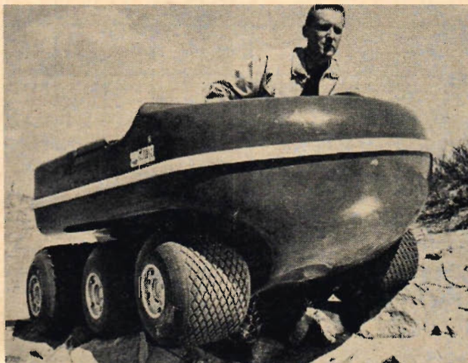
Ett nytt amfibiefordon, den sexhjuliga Terra-Gator, har börjat hårdtestas av amerikanska armén. Terra-Gator har kaross av glasfiber och är avsedd för transport under extremt svåra förhållanden. Tack vare sexhjulsdriften och breda lågtrycksdäck tar den sig fram praktiskt taget överallt. Hjulen fungerar också som drivkälla under gång i vatten.
