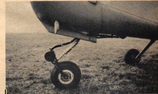
Nosstället har fått en ny typ av fjädring som gör planet mera "terränggående" med tanke på provisoriska, ojämna fält. Den stora klumpen på landställbenet försvinner på seriemodellen.
