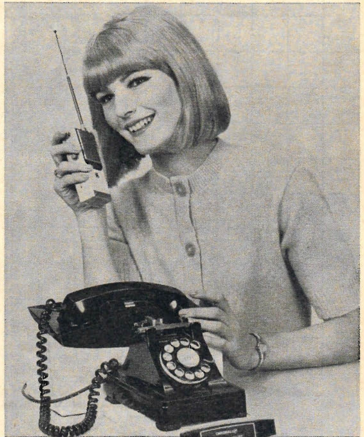
Flickan på bilden ovan demonstrerar hur ficktelefonen fungerar. När telefonen ringer surrar det i ficktelefonen och hon kan ta samtalet i vanlig ordning. Telefonens lur har placerats på en kombinerad mottagare och sändare.
