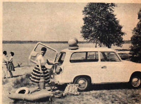
Trabant 600 finns också som kombivagn. Tvåtaktsmotorn är på endast 23 hk, vilket dock räcker för en acceleration från 0 till 80 km/tim på 20,7 sek.
