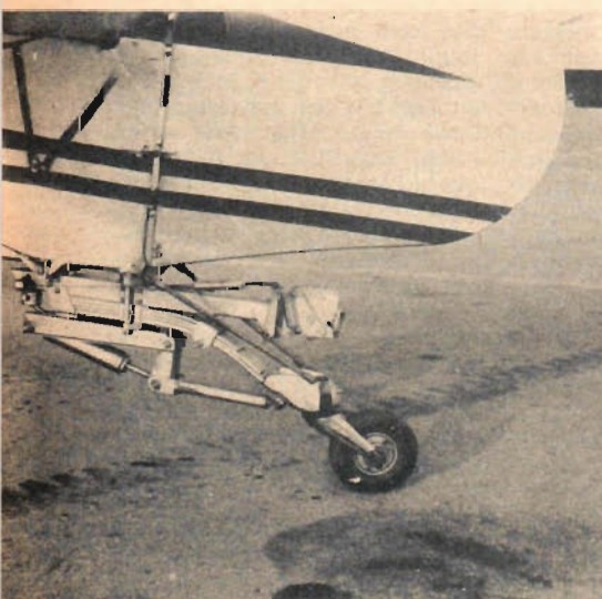
Sporrhjulet styrs genom att det är kopplat till sidorodret. Lägga märke till den hydrauliska stötdämparen och den stabilt monterade bogserkoppningen.
