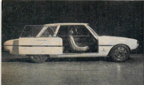
Bilen på den här bilden är en prototyp utan motor. Bilen heter Sigma och är en experimentvagn som man har försökt göra så säker som möjligt. Karossen är byggd av Pininfarina.
