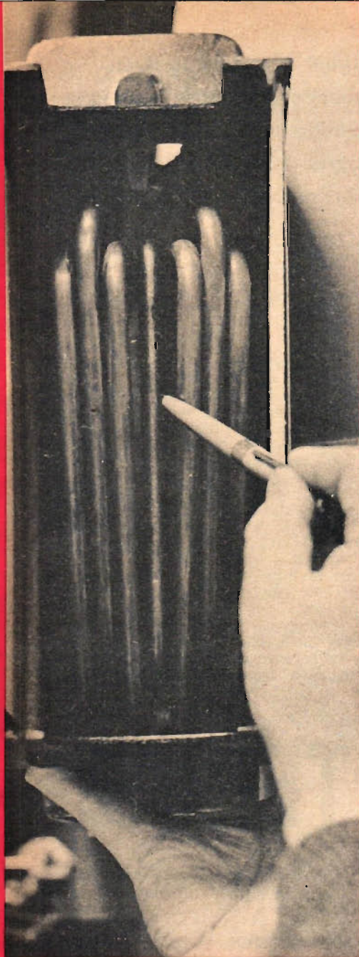
Det rör sig här om maskiner och pannor av helt annan standard än vanliga leksaksångmaskiner. Här är t ex en ångpanna med riktiga ångtuber.
