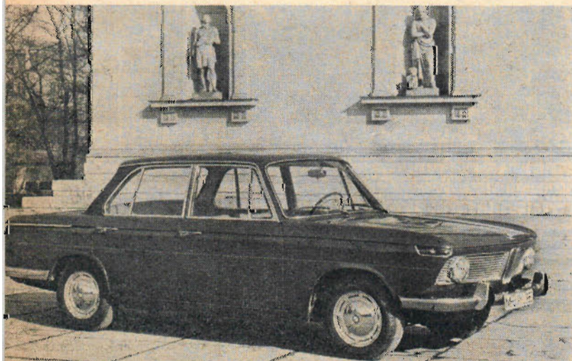
BMW har kommit med en ny modell — 1600. Den har starkare motor än 1500 — 3 hk DIN mer. Den nya BMW:n har en förbättrad acceleration och större smidighet än 1500. Topphastigheten ligger vid 150 km/tim.
