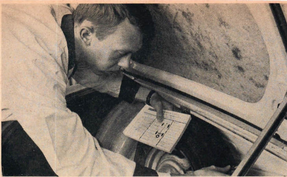
När man kontrollerar sina däck får man naturligtvis inte glömma reserven. Även detta däck måste ha ett mönsterdjup av minst 1 mm.
