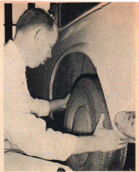
Mekaniska fel kan påverka däckslitage, t ex lagerfel, glapp i spindelbultar o d.
