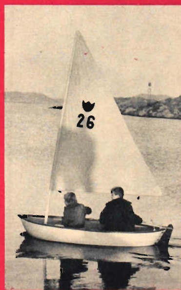
ABC-skalet är en lätt nybörjarsbåt med skrovet i formpressad skalkonstruktion.
