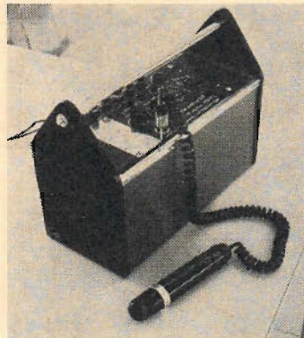
Sändaren är lätt att bära med sig. Strömmen kommer från ett batteri.
