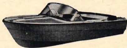
Monark Sport 4,4 (däckad). NYHET! Denna sportbåt är lämplig för fiske, vattenskidåkning och som utflyktsbåt. Skarp V-botten ända akterut, skarp stäv och inbyggda skidlinjer. Längd: 4,27 m. Bredd: 1,60 m. Vikt: 210 kg. Motor max.: 40 hk. Bärighet: 5 pers. Riktpris kr 4.850:— + oms.
