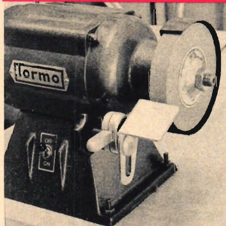
Slipstödet kan höjas, sänkas, vridas och skjutas fram och åter sedan den stora ratten till vänster lossats.
