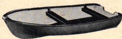
Monark Monarita 4,0 Stabil, bärkraftig, lättdriven, vakar väl. Rund botten med skarp stäv och inbyggda skidlinjer. 2 st mahognytofter med flytelement på undersidan. Artullar och ett par åror. Längd: 4,0 m. Vikt: 120 kg. Motor max.: 18 hk. Bredd: 1,6 m. Riktpris kr 1.850:— + oms.
