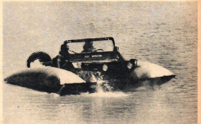
I USA håller man som bäst på att testa ett nytt sätt att forsla fordon över vattendrag. Ett par uppblåsbara plastkuddar monteras på fordonets båda sidor och dessa håller vagnen flytande. Som drivkraft fungerar bilens hjul.
