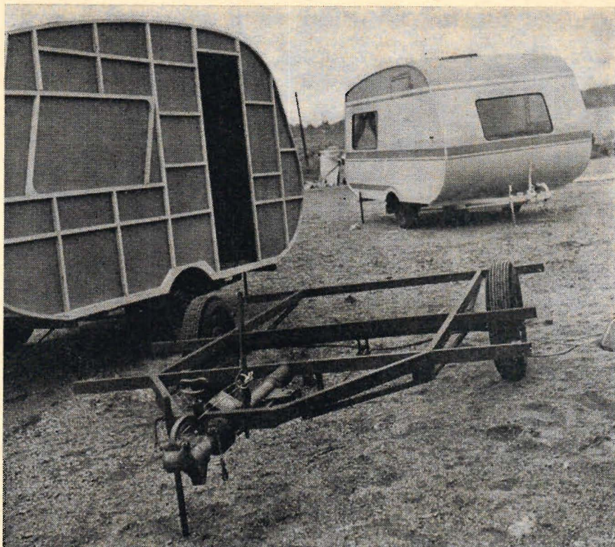
Trailerns tre stadier. Främst ett naket chassi. T v en leveransklar byggsats med resta väggar och i bakgrunden en helt färdig Il-600.
