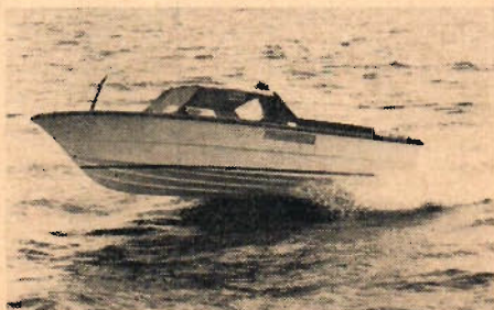
Bottenstegen syns tydligt på denna bild. Havsörnen är utförd i ett kraftigt dimensionerat glasfiberlaminat och skrovet torde tåla åtskilligt.
