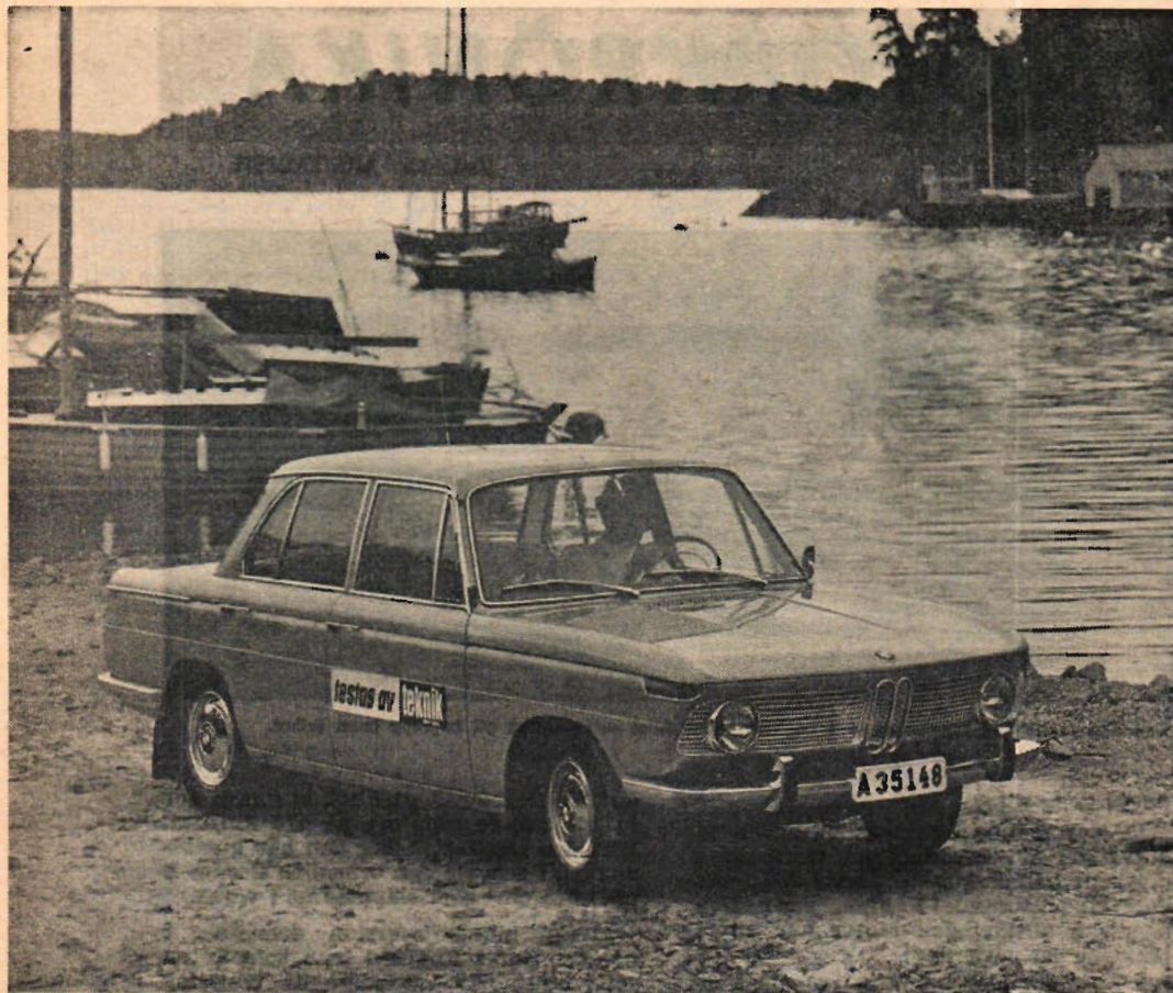
Det utmärkande för den tyska BMW 1800 TI är stilren internationell formgivning parad med goda prestanda. TI-modellen är 2 000 kronor dyrare än den vanliga 1800-modellen vilken har en motor som utvecklar 102 hk SAE mot TI-modellens 124 hk SAE. Båda motorerna har en cylindervolym av 1 773 cm 3 .
