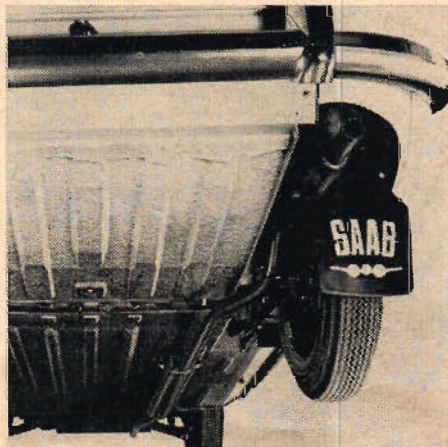
Nya SAAB går tystare tack vare ett nytt avgassystem. Avgasröret har en gren som är tillsluten i den bakre änden. Där bildar avgaserna en kudde som tar upp en del av ljudet. Även den bakre ljuddämparen är omkonstruerad och effektivare.
