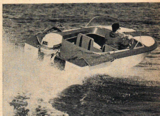
De finns fyra sittplatser ombord. Dubbelbotten är försedd med skumplastmellanlägg och flytbarheten ökas ytterligare med skumplastblock under däck.
