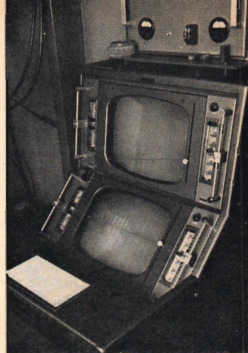
Det är med den här precisionsradarns hjälp som flygplanen pratas ner i dåligt väder. Planen syns på precisionsradarns två PPI:n dels i sidled, dels i höjdd. Radarn är ett komplement till ILS-en.
