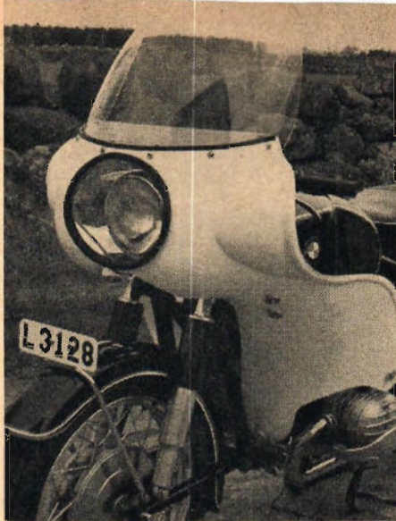
På denna maskin har man bibehållit originalstrålkastaren och satt in en bit plexiglas i kåpan.
