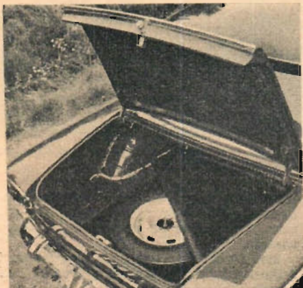
Reservhjulet och verktygsatsen ligger under maten i bagageutrymmet som är stort.
