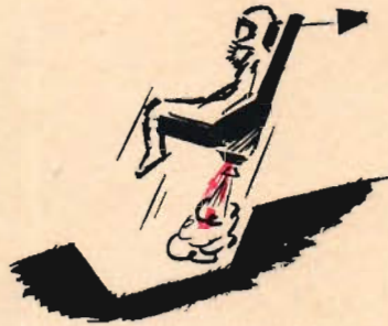
2 Stolraketen tänds och stolens stabiliseringskärm skjuts ut.
