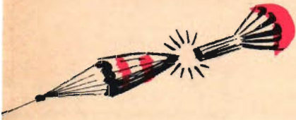
8 Efter 3 sek lossnar bromsskärmen och stabiliseringskärmen utvecklas.
