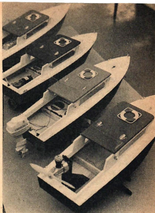
Wentzels visade sin nya modellbåtsbyggsats, en ca 50 cm lång båt i balsa och plywood som kan förses med fyra olika motoralternativ, nämligen inombordare, utbordare, inu-drev eller luftpropeller.
