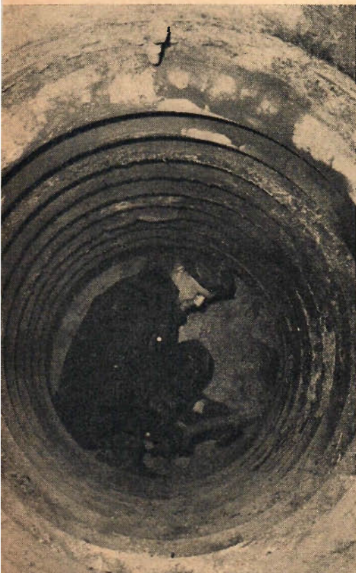
När hon väl var på rätt köl, vidtog den tidsödande rengöringen av panna och maskin.
