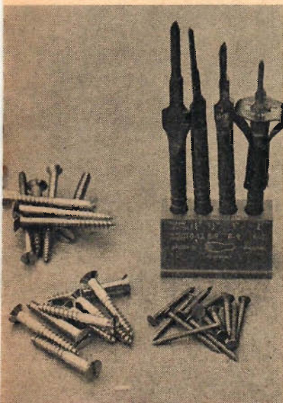
Mässingskruv och rullgångad s k Gripfast-spik använde vid båtbygge. T h borrh- och försänkarsats.
